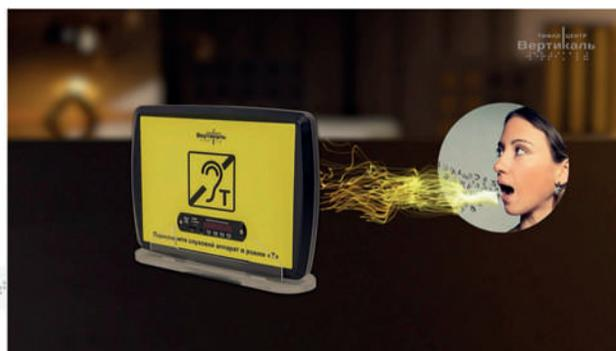
Далее необходимо выбрать режим приёма голоса между встраиваемым и выносным микрофоном. Потом следует выбрать режим работы устройства «Контур» для работы в обычном режиме, а при необходимости приёма информации со сторонних устройств — выбрать режим «MP3».
